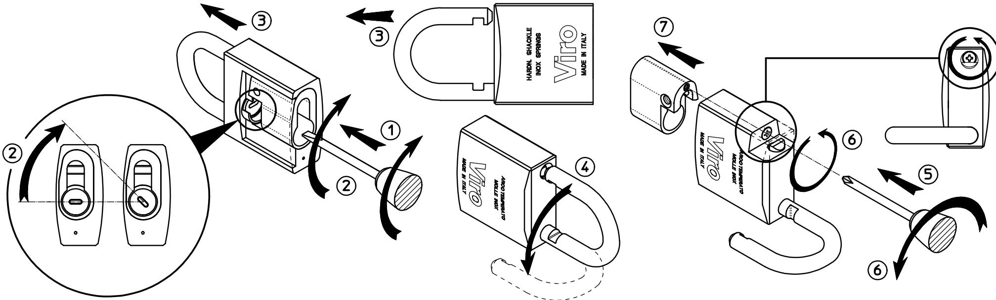
(I) Il lucchetto rettangolare art.304.MC e' predisposto per l'utilizzo di qualsiasi mezzo cilindro avente nottolino DIN o universale e le caratteristiche indicate nel riquadro (ad esempio gli articoli Viro 1.772, 975.1, 875.30.10 o 880.30.10). N.B.: il cilindro non e' fornito in dotazione.
