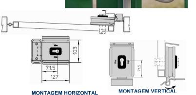
"V06" UNIVERSAL DE TRINCO ROTATIVO, COM FUNZÇÃO DE SERVIÇO E FUNÇÃO DE SECGURANÇA ADAPTADA A TODO O TIPO DE INSTALAÇÃO
