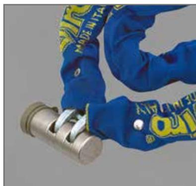
Catena semiquadra di sezione 10 mm in acciaio speciale al manganese, cementato, temprato e zincato, protetta da guaina in tessuto blu che minimizza l'ingombro
