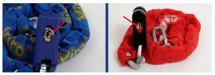
Come si vede dalle foto il Supermorso Viro (a sinistra), sotto il tappo plastico a slitta, ha la serratura protetta da una piastrina in acciaio cementato antitrapano, la copia (a destra) no. Questo rende la serratura del prodotto imitazione molto più vulnerabile agli attacchi portati trapanando il barilotto.
