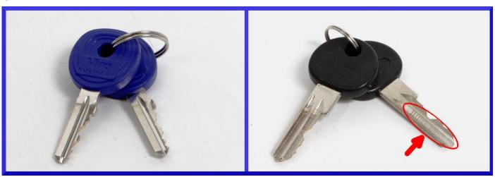
Le chiavi offrono un indizio della precisione delle lavorazioni impiegate per la realizzazione dei prodotti. Le chiavi Viro (a sinistra) appaiono lisce e prive di imperfezioni, quelle della copia (a destra) mostrano i segni di una fresatura "saltellante" e approssimativa. Il meccanismo di un lucchetto realizzato con precisione resiste meglio ai tentativi di aprirlo con destrezza e garantisce una maggiore durata nel tempo, rispetto ad uno realizzato con tolleranze ampie e lavorazioni imprecise.
