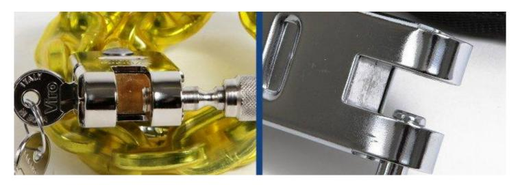
Nella foto di sinistra si può vedere come il corpo all'interno della corazzatura abbia l'inconfondibile colore giallo dell'ottone. Il corpo della copia, invece ha il colore tipico dell'alluminio perché è realizzato in zama, una lega formata prevalentemente da zinco e alluminio. Le caratteristiche meccaniche dell'ottone sono decisamente superiori a quelle della lega zama, come si vede da questa tabella:
