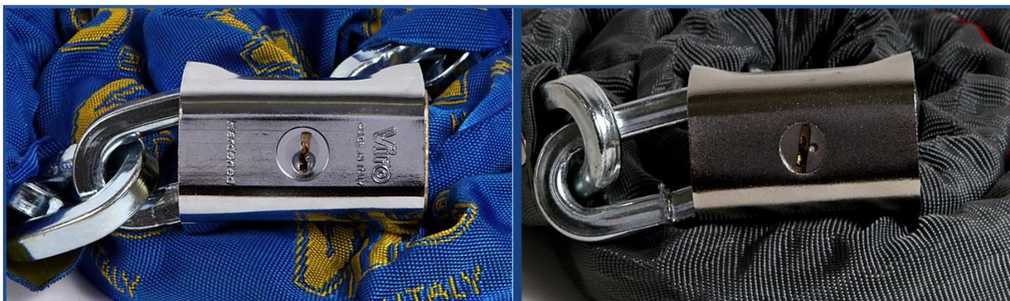
La riprova che la copia ha sostenuto trattamenti chimici di livello nettamente inferiore rispetto all’originale Viro, ci è stata fornita dal risultato del test in nebbia salina (un processo di “invecchiamento accelerato” attraverso la creazione, in una speciale macchina, di un ambiente estremamente caldo, umido e corrosivo, ove i prodotti subiscono, ogni ora di test, circa l’equivalente di una settimana di esposizione ad ogni tipo di agente atmosferico aggressivo).
