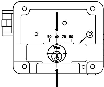
ASSE CILINDRO- CYLINDER AXIS-ZILNDERACHSE-ОСЬ ЦИЛИНДРА -CILINDRO
